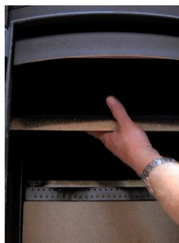
Man skal sikre sig, at røgledeplader og sten igen er korrekt monteret inden optænding efter en rensning.
