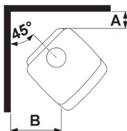
Af hensyn til varmecirkulation, rengøring og evt. indvendig rensning af ovn, anbefales afstand til murværk at være 10-15 cm. Et lag tapet bliver normalt, når det er påsat murværk, betragtet som ikke-brændbart materiale.
